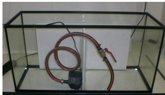
FIGURE 36 – Photo du dispositif à une pompe, avec tuyau et vanne
