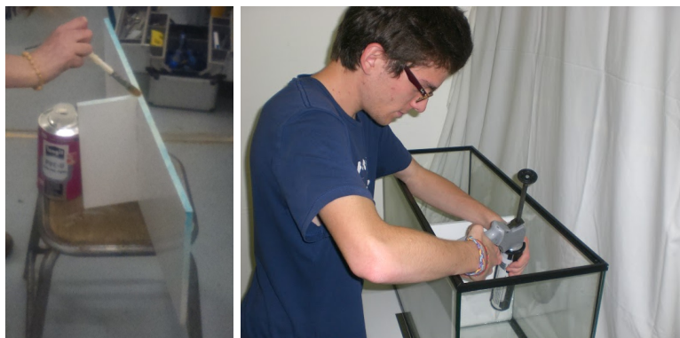
FIGURE 29 – Photos de l'opération d'application de la colle (à gauche) et du joint silicone (à droite)
