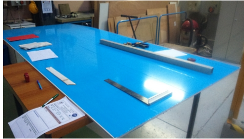
FIGURE 26 – Photo de la plaque de PVC expansé Celuka de 3 \times 1,25 \text{ m}
