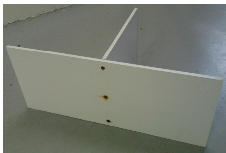
FIGURE 28 – Photo des deux plaques de Celuka assemblées en T
