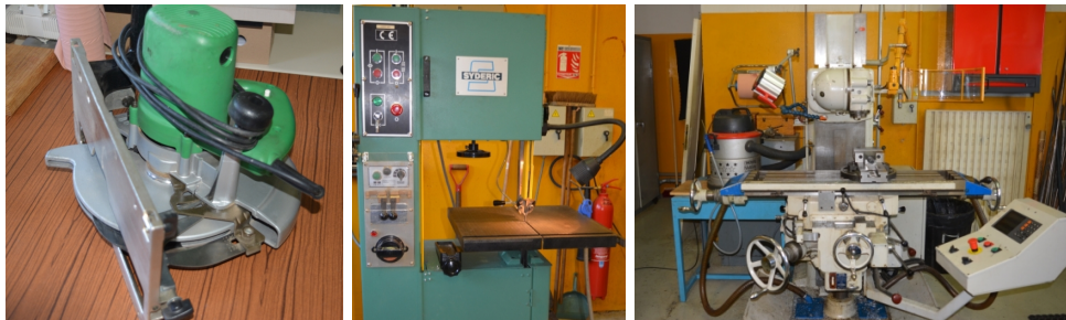
FIGURE 27 – Photos de la scie circulaire (à gauche), de la scie à ruban (au centre) et de la fraiseuse (à droite)
