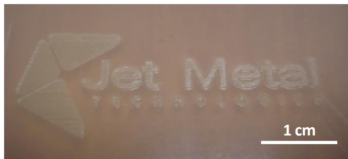
Figure 1-26 : Texturation locale obtenue sur polypropylène par irradiation laser femtoseconde.
