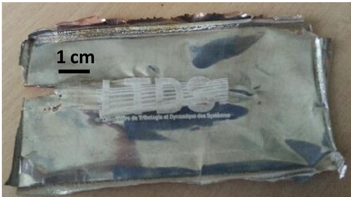
Figure 4-45 : Électroformage du logo du LTDS obtenu par texturation laser à P = 550 \text{ mW} , N = 50 et recouvrement de 50 % des impacts. Le revêtement métallique est de 100 \mu\text{m} et est retiré par décollement.
