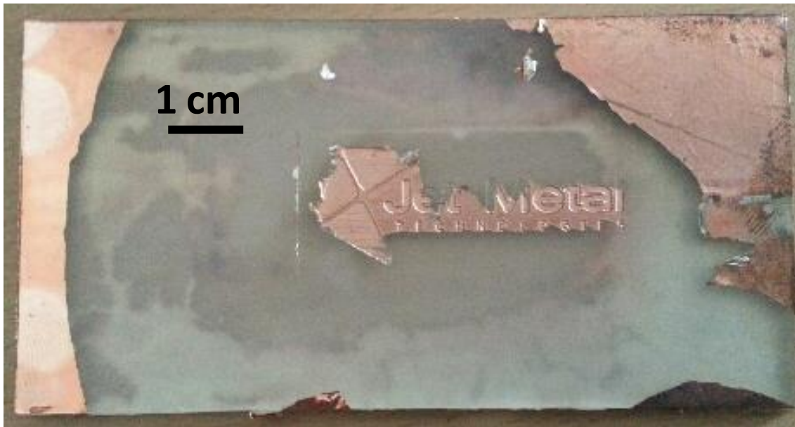
Figure 4-43 : Métallisation du logo Jet-Metal obtenue par texturation laser à P = 550 mW, N = 50 et recouvrement de 50 % des impacts. Le revêtement métallique déposé par DCP et bain électrolytique est de 20\ \mu\text{m} . Il est retiré par décollement.
