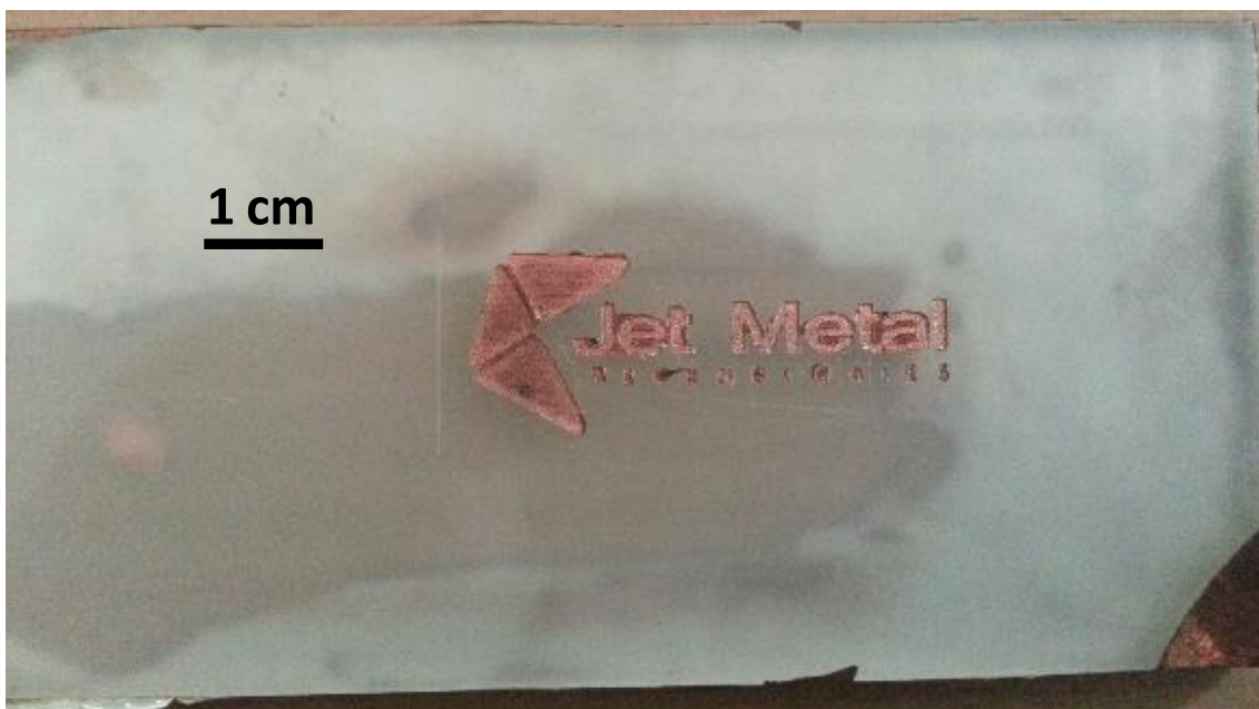
Figure 4-44 : Métallisation du logo Jet-Metal obtenue par texturation laser à P = 950 mW, N = 200 et recouvrement de 50 % des impacts. Le revêtement métallique déposé par DCP et bain électrolytique est de 20\ \mu\text{m} . Il est retiré par décollement.
