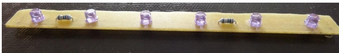
Figure 74 : Système électronique réalisé pour faire fonctionner les LED infrarouges
