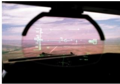
Figure 22 : Utilisation d'un HUD dans un avion
