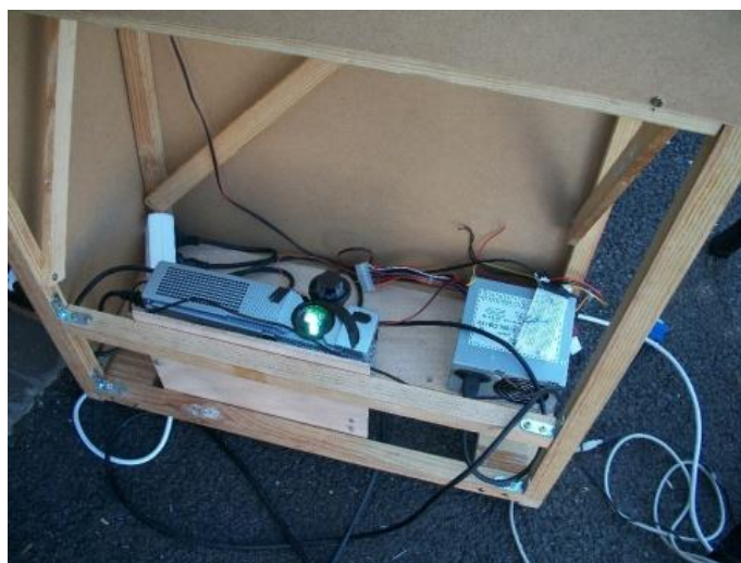
Figure 73 : Photo du pupitre en cours de construction, vidéoprojecteur, caméra et alimentation
