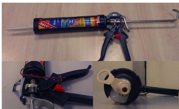
Figure 82 : Pistolet à colle infrarouge réalisé
