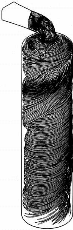
FIG. 1.8 – Schéma des trajectoires des particules dans une chambre de combustion avec injection de type swirl , tirée du site internet www.cyclone.nl .
