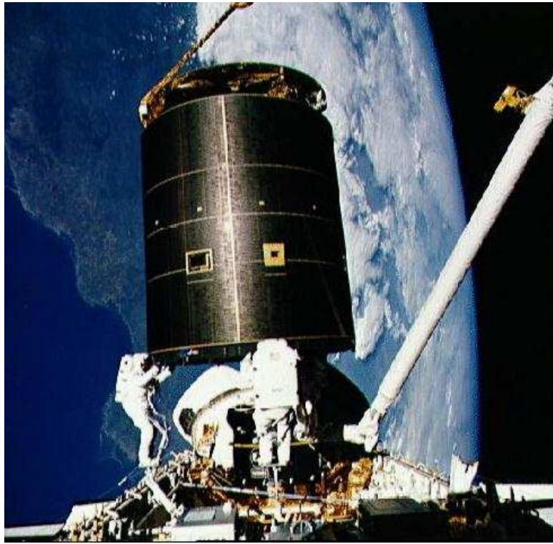
FIG. 1.5 – Photographie du satellite de communication géostationnaire Intelsat 603 lors d'une mission de réparation en mai 1992 (tirée du site internet http://satobs.org/ ). Hormis les antennes et les panneaux censés garder une cap fixe par rapport à la terre, l'ensemble de ce satellite de type Hughes HS est mis en rotation autour de son axe principal à une vitesse angulaire de 55 rpm.
