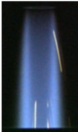
Figure C-61 : visualisation directe de la flamme et des trajectoires de particules (zone de la buse)
