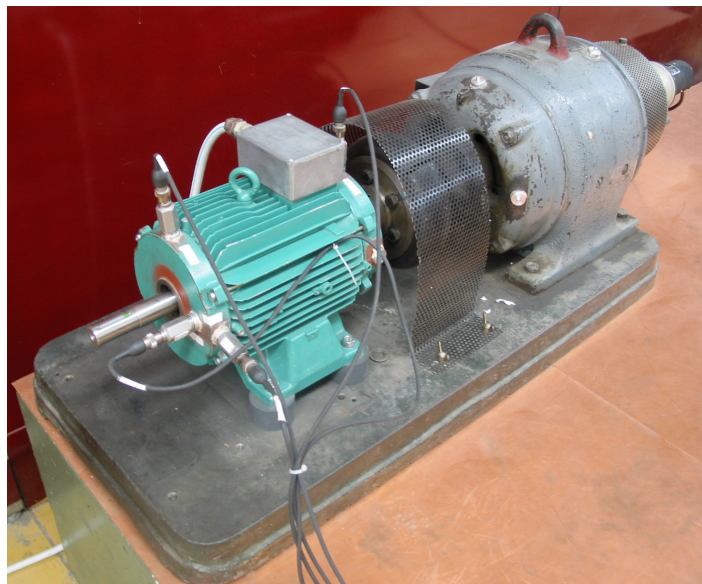
Fig. 3. 1. Photo du banc moteur 5,5 kW dédié au diagnostic.
