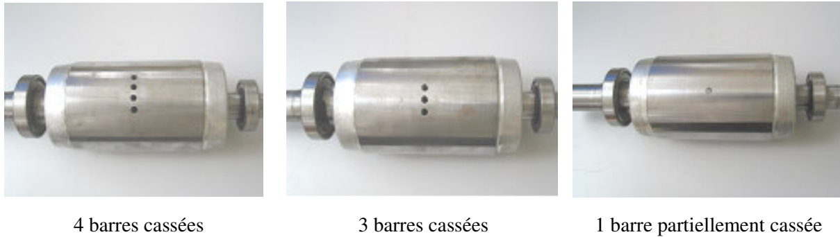
Fig. 3. 3. Photos des rotors utilisés
