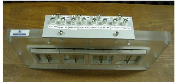
FIG. 5.4 - Représentation schématique du prototype 4 cellules (tissu résistif non représenté)
