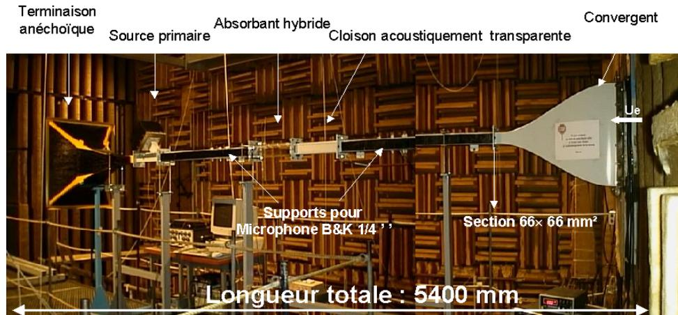
FIG. 1.21 - Montage expérimental du traitement actif en veine
