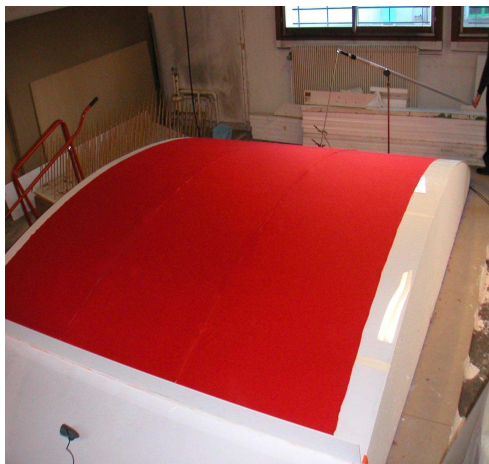
Figure 4-2 : Surface convexe en conditions homogènes, analogie avec un profil linéaire réfractant vers le haut au-dessus d'une surface plane.
