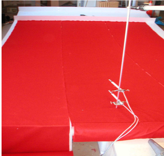
Figure 4-1 : Surface concave en conditions homogènes, analogie avec un profil linéaire réfractant vers le bas au-dessus d'une surface plane.
