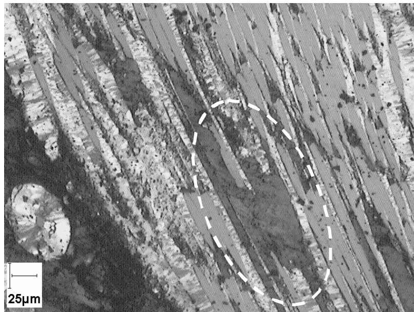
Fig. 26 : Observation au microscope optique d'un agglomérat de 3 ème corps au niveau de la rupture de fibres parallèles après les iso-freinages TC5
