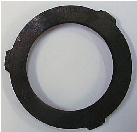
Fig. 9 : Eprouvettes utilisées sur le banc d'essai BETSI
