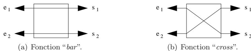
FIG. 1.14 – États fonctionnels d'un *switch* élémentaire qui compose un *crossbar*.
