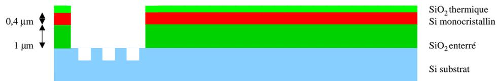
FIG. C.2 – Lithographie des réseaux d’alignement
