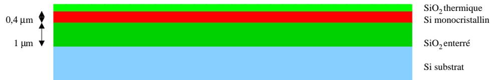
FIG. C.1 – *Wafer* de départ de la filière utilisée pour le lot MOM2
