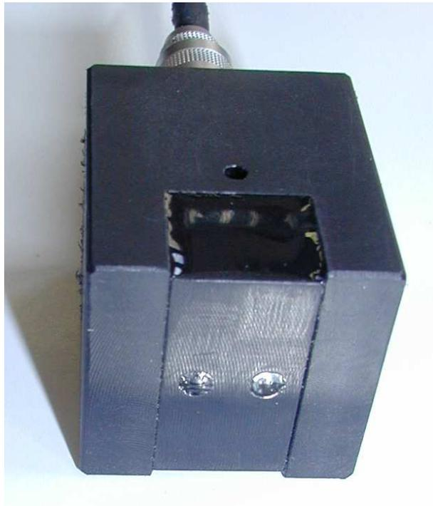
FIG. IV.2.10 – Photographie du capteur TTA SF 10678.
