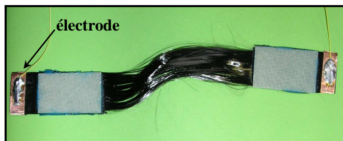
Figure V-1: Mèche en fibres de carbone pour l'essai de traction
