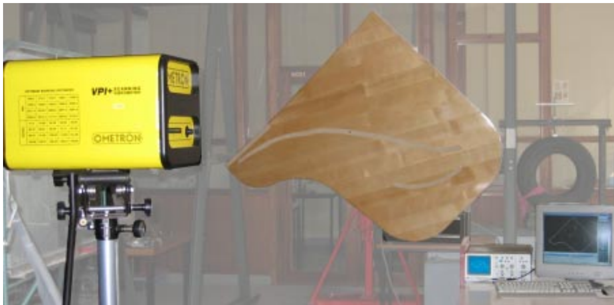
FIG. V.28: Photo du banc de mesure avec la table d'harmonie et le Laser (chaîne de mesure)
