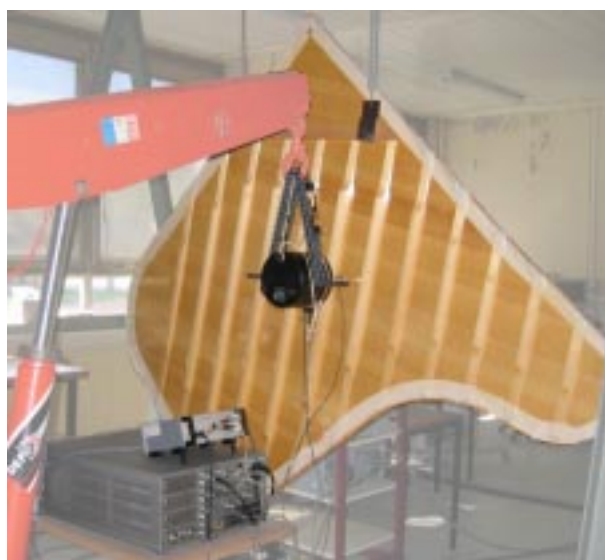
FIG. V.29: Photo du banc de mesure avec la table d'harmonie et le Laser (chaîne d'excitation et raidisseurs)
