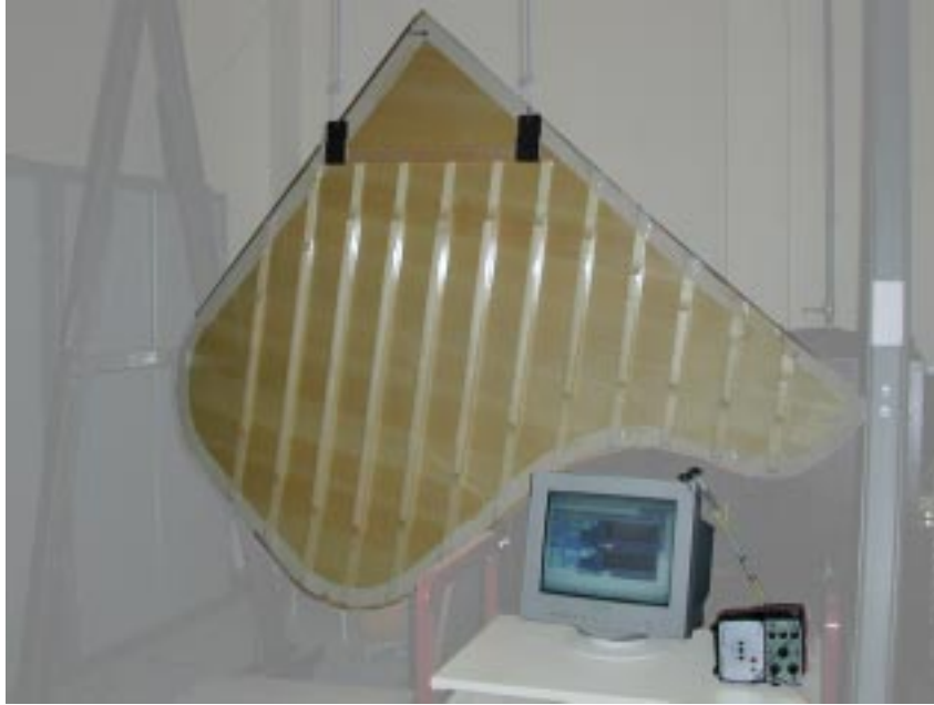
FIG. V.14: Banc de mesure pour expertise modale
