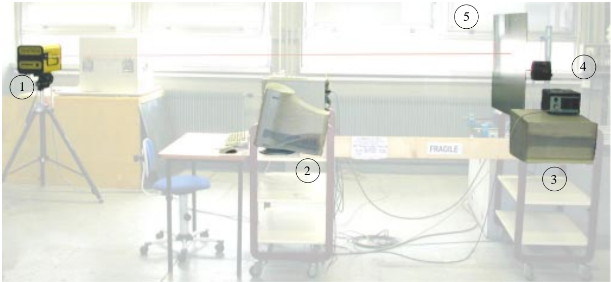
1 : Laser à balayage 2 : Pilotage laser, pilotage Paragon, stockage données 3 : Echantillonneur HP Paragon 4 : Chaîne d'excitation 5 : plaque testée
