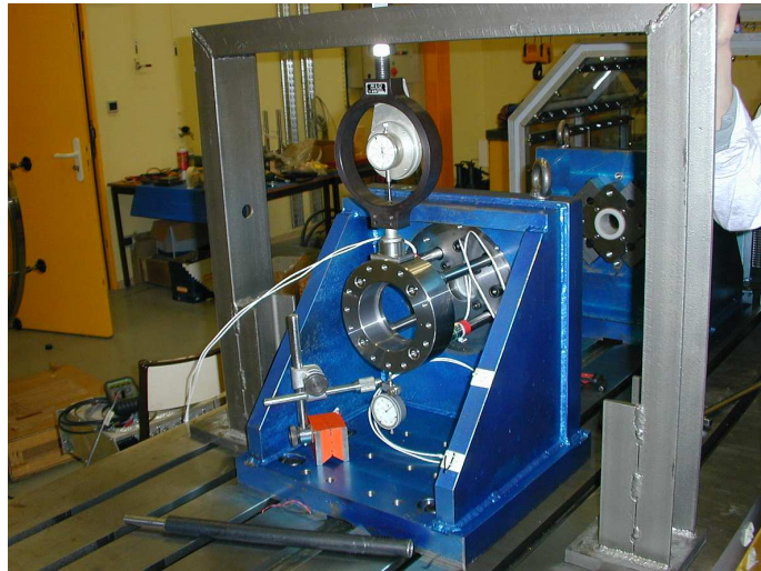
FIG. 4.6 – Montage expérimental pour la mesure de la raideur en flexion du support palier
