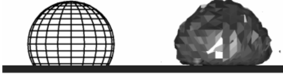
FIG. III.11: Simulation d'une bulle sur un plan dans la direction [100] ( w_{mf}/w_{ff} = 0.3 , T/T_c = 0.4 , 1500 sites de liquides. Comparaison avec une bulle macroscopique formant un angle de contact de 120^\circ . \kappa = 0.02 .
