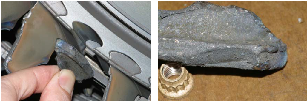
Figure 1.5 Aube de compresseur haute pression éjectée suite à la propagation d'une fissure de fatigue initiée en fretting
