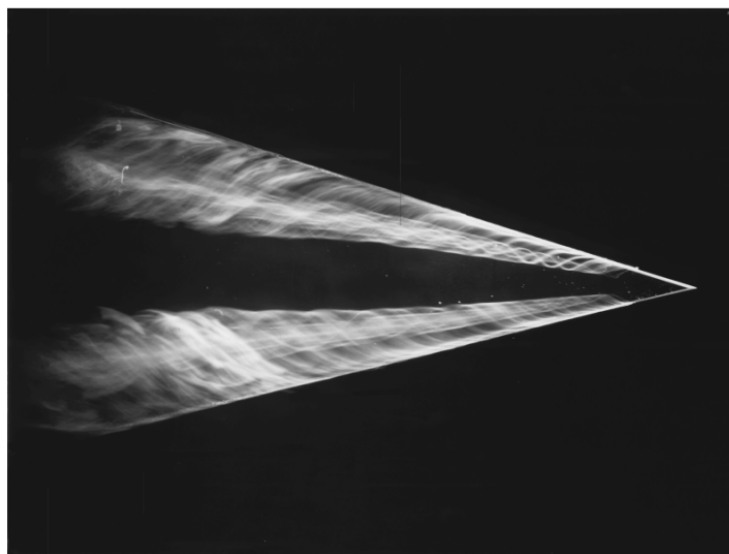
Fig 4.3: Exemple de décollement tridimensionnel ; tourbillons émis au bord d'attaque d'une aile delta à 75 ° en incidence.
