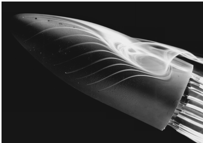
Fig 4.11: Visualisation expérimentale d'une séparation topologique à la surface d'un corps émoussé à symétrie de révolution (J. M. Déleroy 2001)
