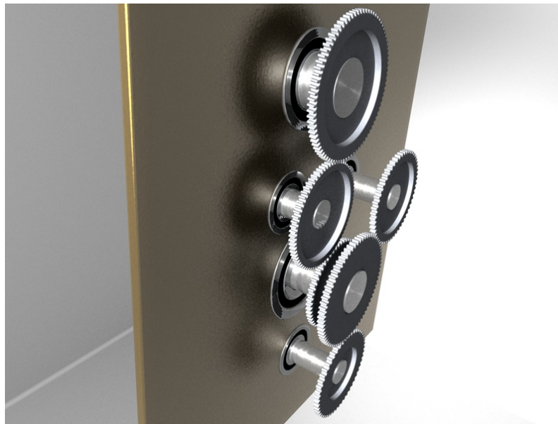
Figure 3.22. : Schéma de la cascade de dentures : arbres, pignons, roulements et plaque support.
