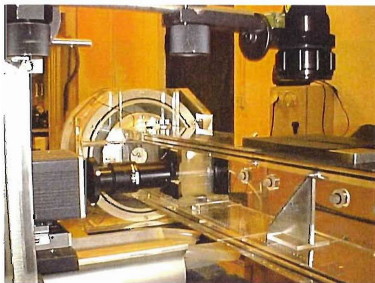
Figure F.13: Photographie du banc de mesure servant à la vélocimétrie par images de particules, où un miroir à 45^\circ permet de renvoyer la lumière du plan laser parallèlement à l'axe du tube (cf. figure 4.5). Au premier plan, on distingue le support triangulaire du miroir étroit, illuminé verticalement par le système optique laser. A gauche, on peut voir la caméra électronique équipée d'un objectif spécial pour microscopie. A l'arrière plan, on distingue le caisson entourant le haut-parleur, sur la membrane duquel est collé un accéléromètre au milieu d'un petit disque blanc en plastique.
