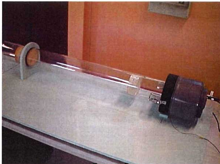
Figure F.1: Vue générale du premier système thermoacoustique étudié. A l'extrémité droite du tube, on peut voir le capot qui entoure le haut-parleur. A l'extrémité gauche du tube se trouve le bouchon rigide. Dans la première partie du tube, en partant de la droite, on distingue la présence de l'empilement de plaques.
