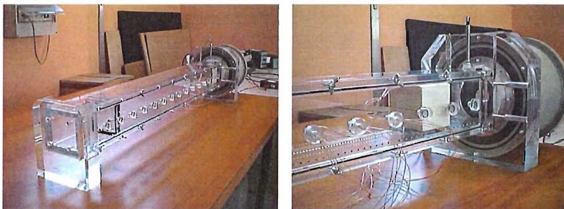
Figure F.4: Photographies du résonateur de section carrée constituant l'élément principal du banc de mesure thermoacoustique. Sur le cliché de droite, on peut voir un stack en céramique à pores carrés placé à l'intérieur du résonateur. Ce stack est instrumenté à l'aide de thermocouples miniatures dont on peut distinguer les fils traversant une des parois en Plexiglas.
